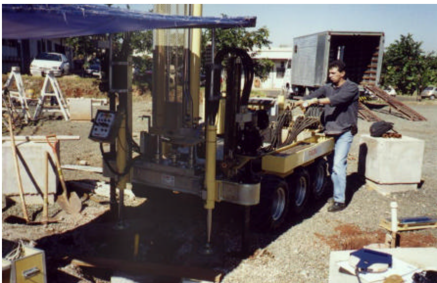
Foto 4.20 – Vista do equipamento do ensaio de cone elétrico.
