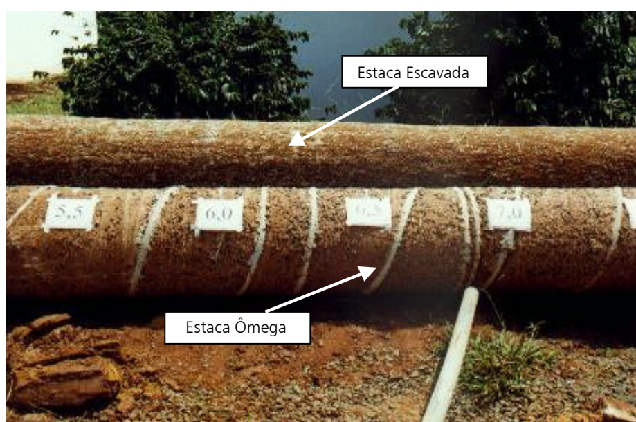
Foto 4.10 - Estaca ômega no trecho de 5,5 a 7,5m de profundidade.
