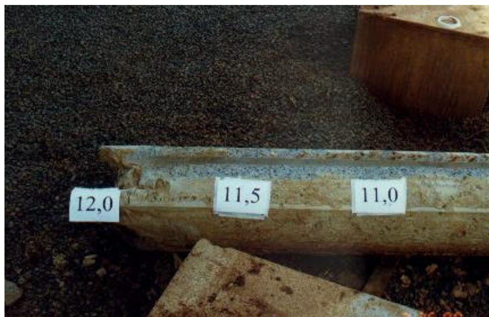
Foto 4.14 - Estaca hélice contínua 2 – ponta.
