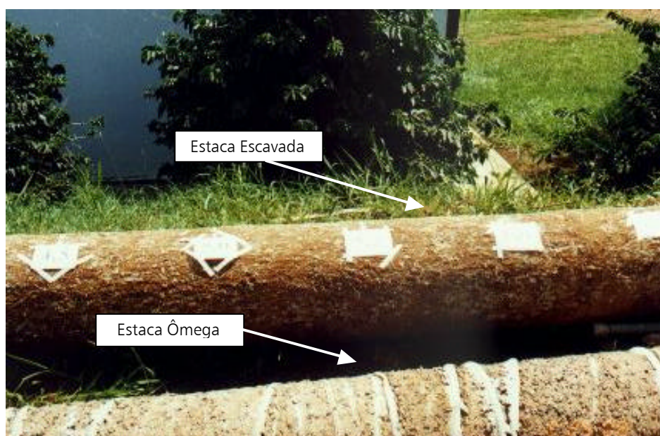
Foto 4.17- Aspecto do fuste da estaca escavada 1 (2º Plano) e da estaca ômega 2 (1º Plano).
