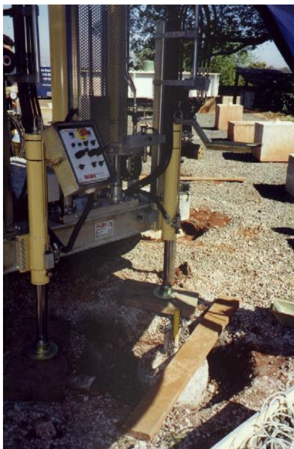
Foto 4.21 - Detalhe do ensaio de cone elétrico.
